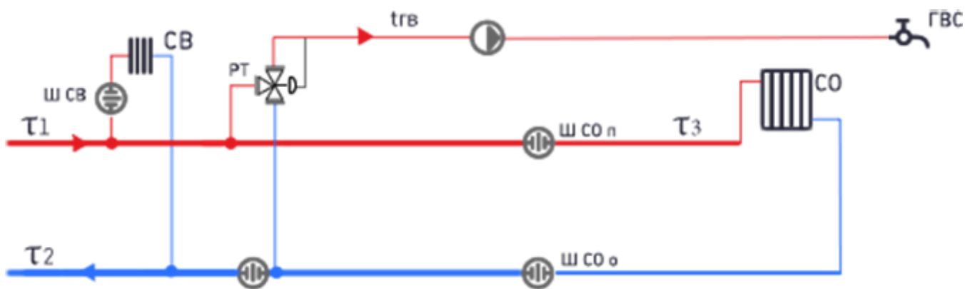
Рисунок 1.1 - Потребитель с открытым водоразбором на ГВС без циркуляции и непосредственным присоединением СО
