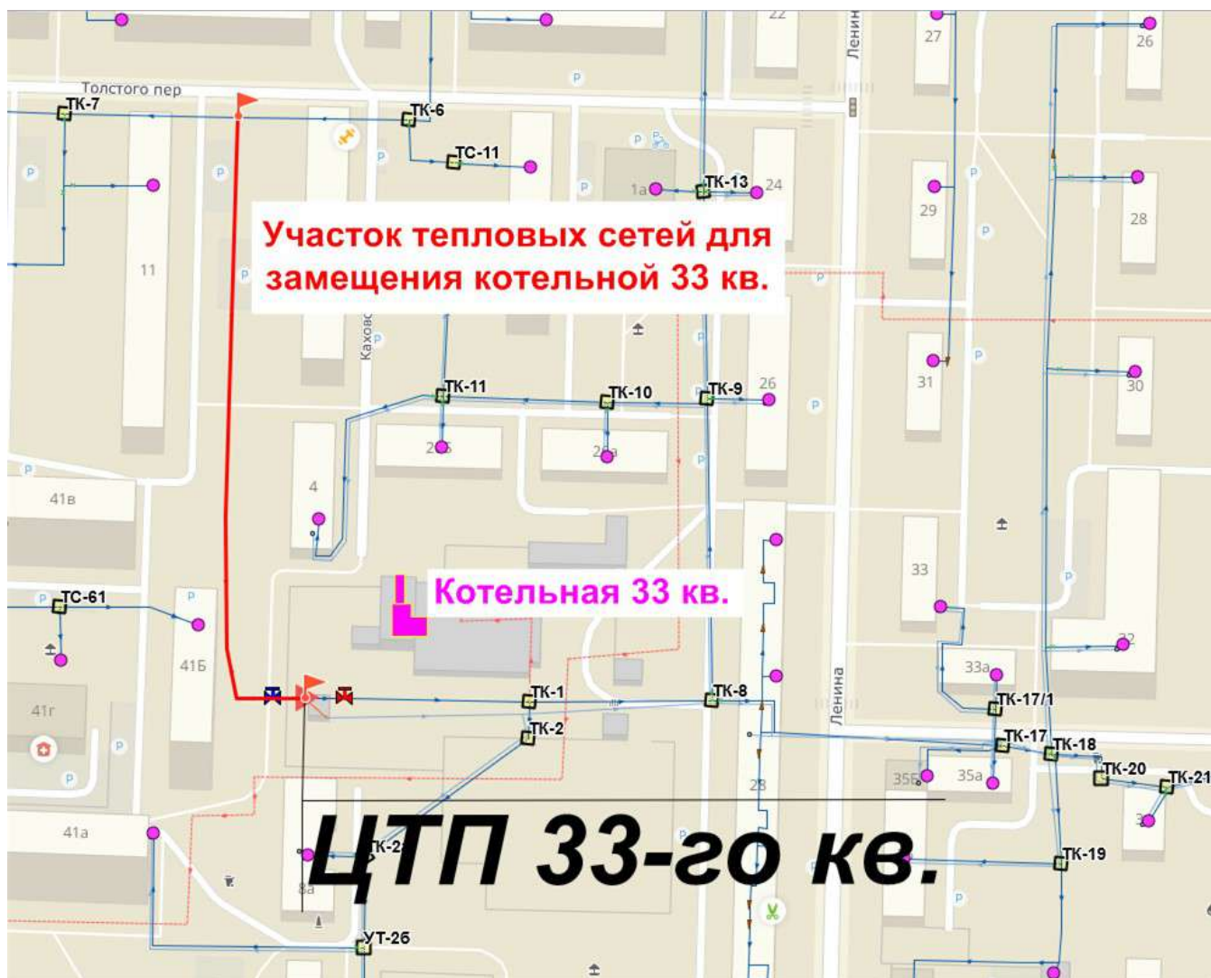
Рисунок 4.1.6 – Участок тепловых сетей от Беловской ГРЭС, строительство которого реализовано для замещения котельной 33 квартала
