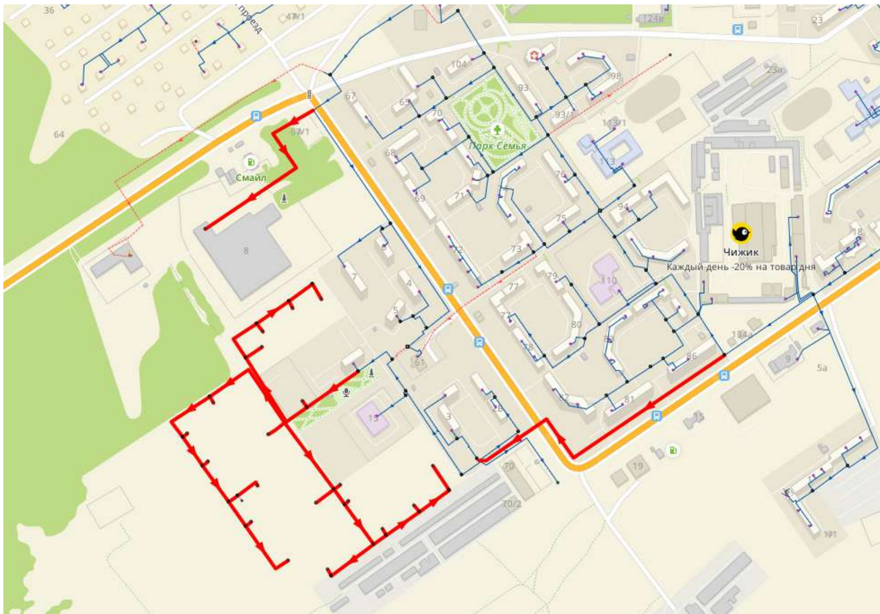
Рисунок 2.1.1 – Строительство тепловых сетей для обеспечения перспективных приростов тепловой нагрузки в микрорайоне Сосновый
