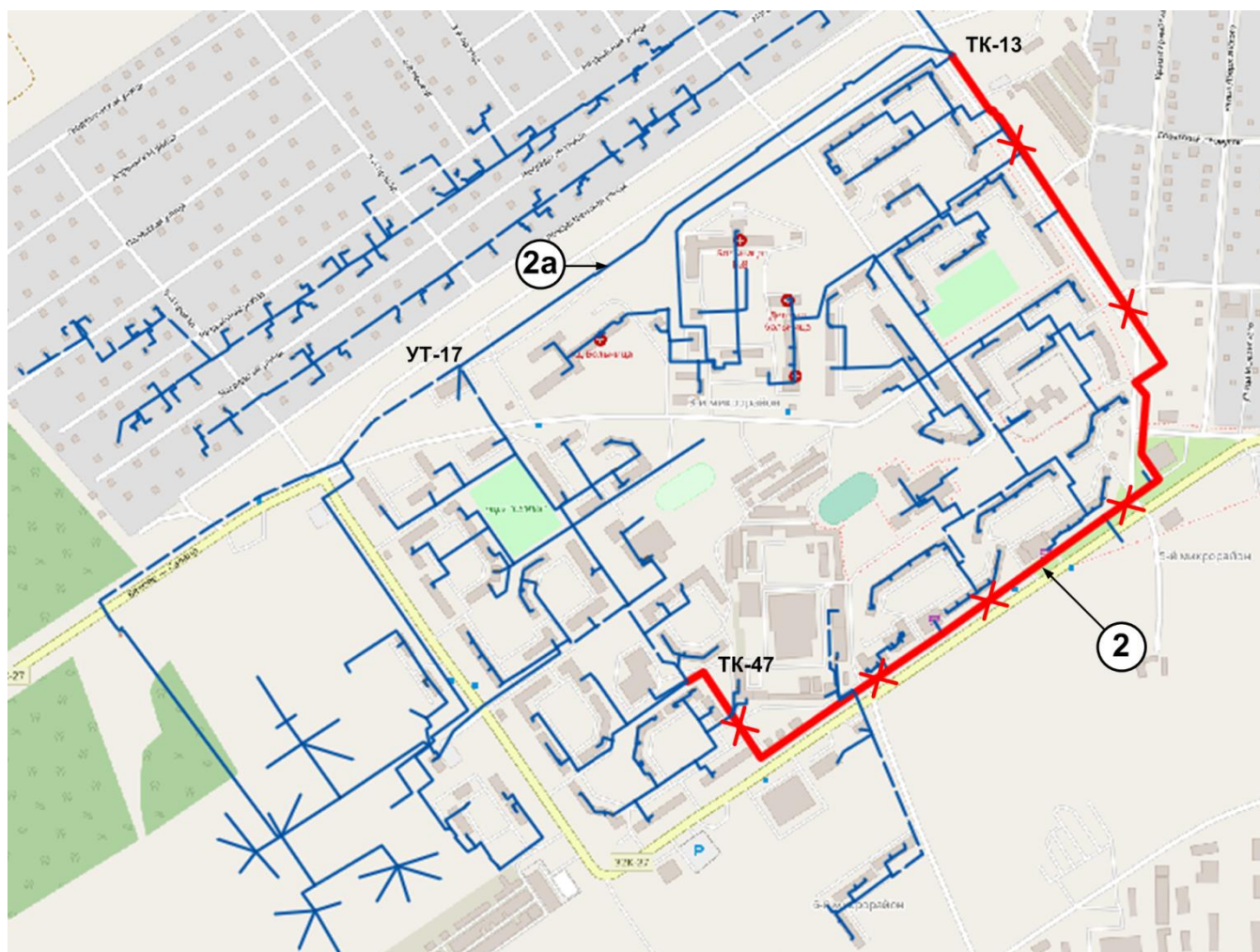
Рис. 8.3.4 Участок ТМ-3 подземной прокладки №2 от ТК-13 до ТК-47
