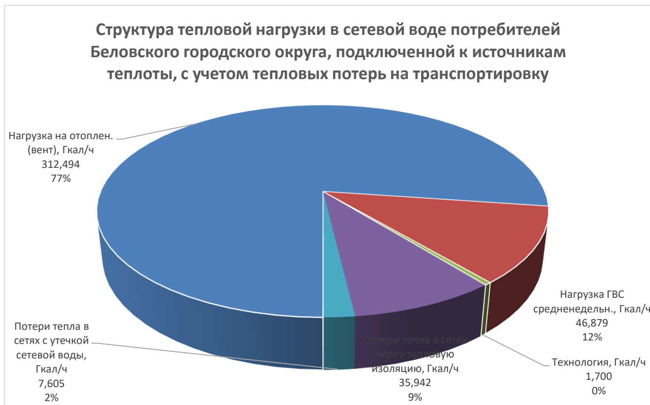
Рис. 5.2.1. Структура тепловой нагрузки в сетевой воде потребителей Беловского городского округа, подключенной к источникам теплоты, с учетом тепловых потерь на транспортировку
