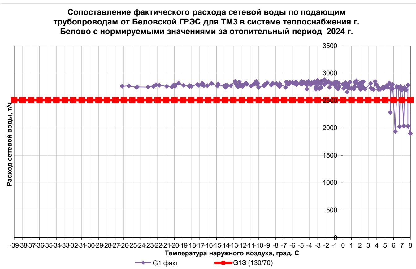
Рис. 1.6.3. Анализ фактических расходов теплоносителя на коллекторах Беловской ГРЭС (ТМ-3)
