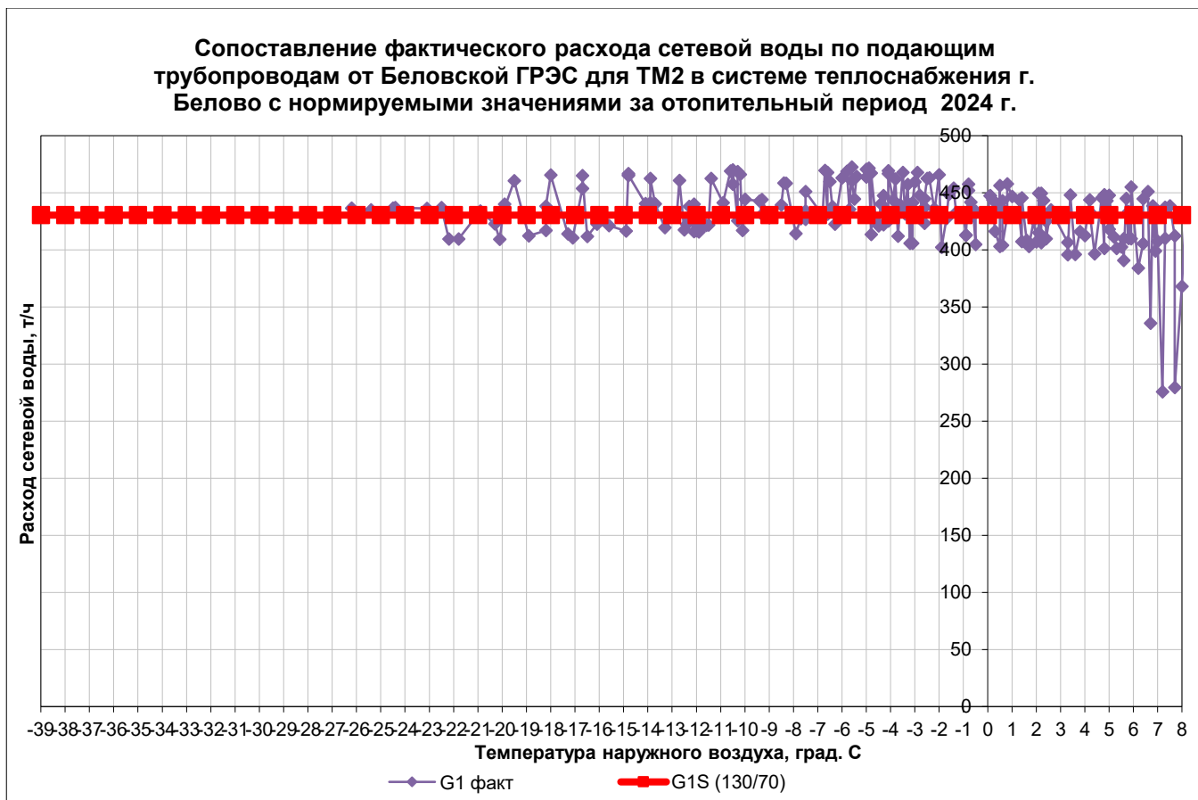
Рис. 1.6.2. Анализ фактических расходов теплоносителя на коллекторах Беловской ГРЭС (ТМ-2)
