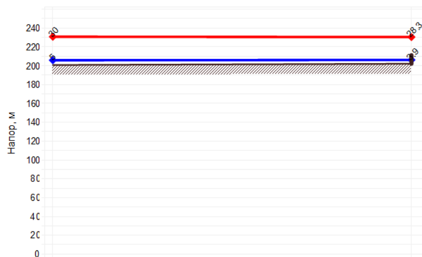
Пьезометрический график от «Котельная школы №7» до «Школа №7, Фрунзе, 3»
