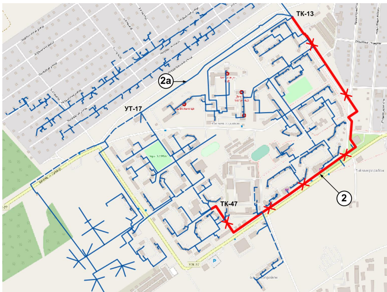
Рис. 5.3.4 Участок ТМ-3 подземной прокладки №2 от ТК-13 до ТК-47
