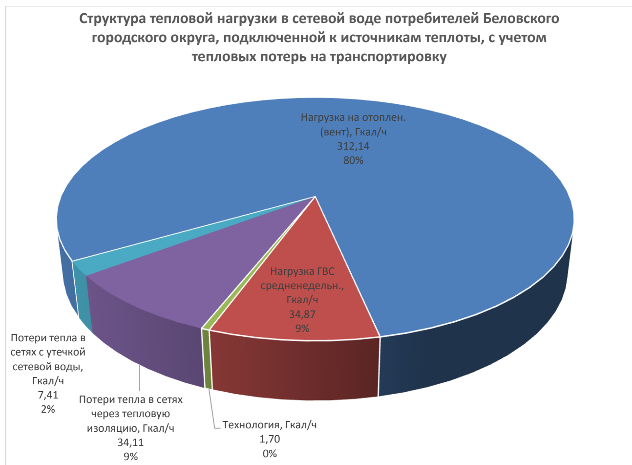
Рис. 5.2.1. Структура тепловой нагрузки в сетевой воде потребителей Беловского городского округа, подключенной к источникам теплоты, с учетом тепловых потерь на транспортировку
