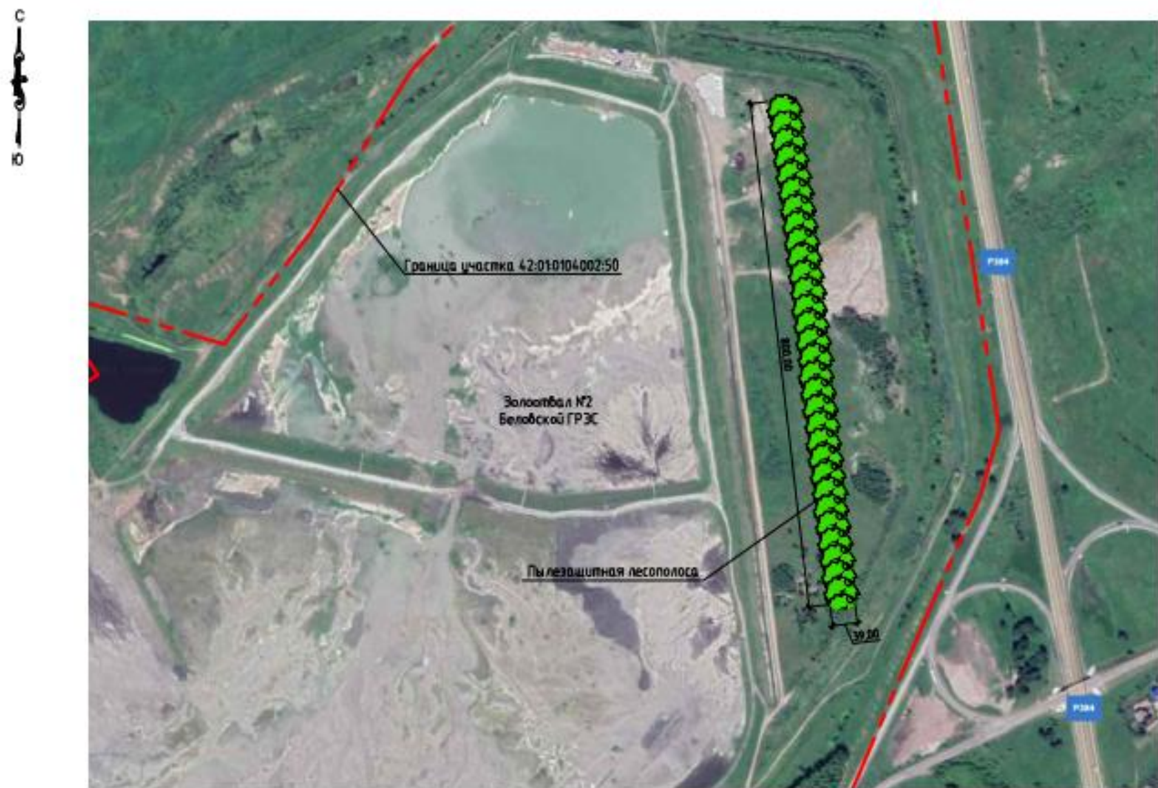
Схема посадки деревьев в пылезащитной полосе
