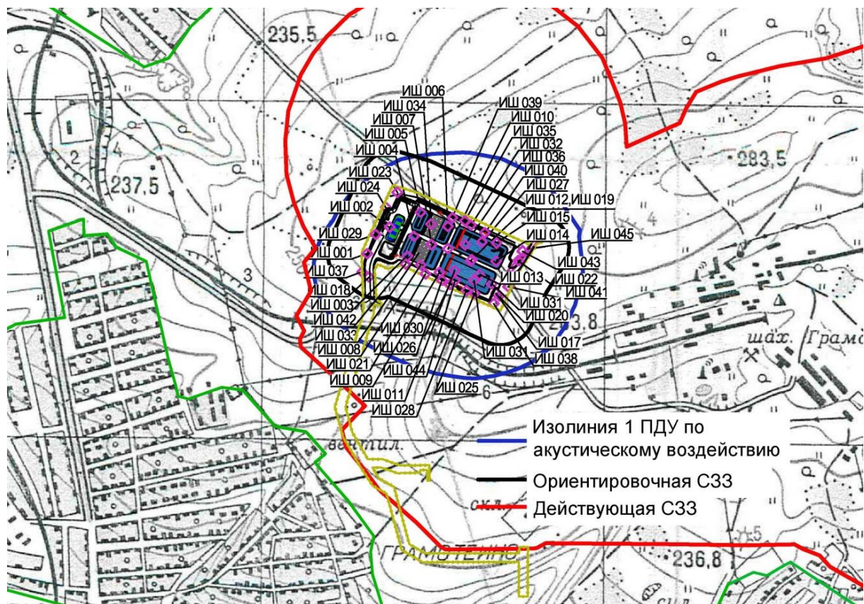
Рисунок 3 – Изолиния 1 ПДУ по акустическому воздействию и источники шума на период строительства
