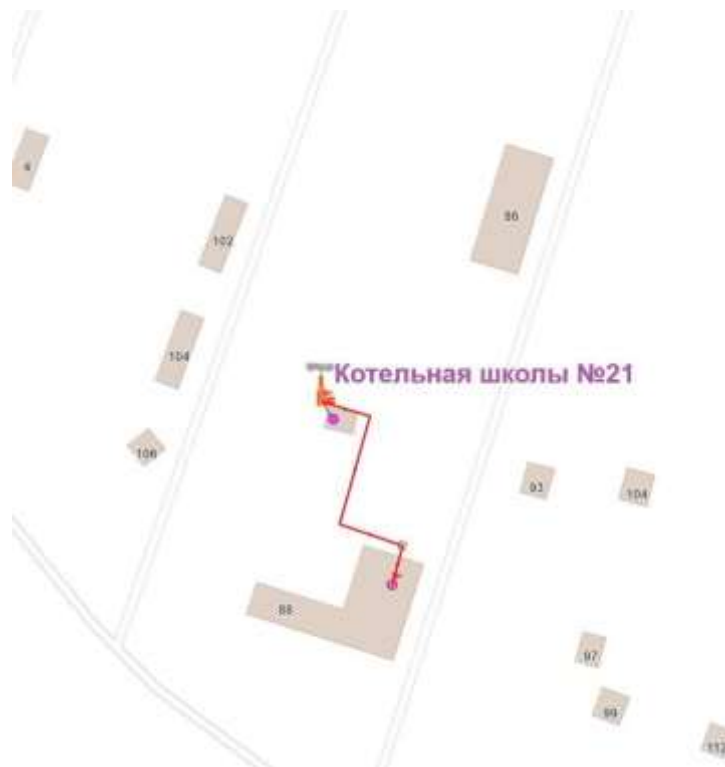
Рис. 13. Путь движения теплоносителя от котельной школы №21 ООО "Теплоэнергетик" до конечного потребителя
