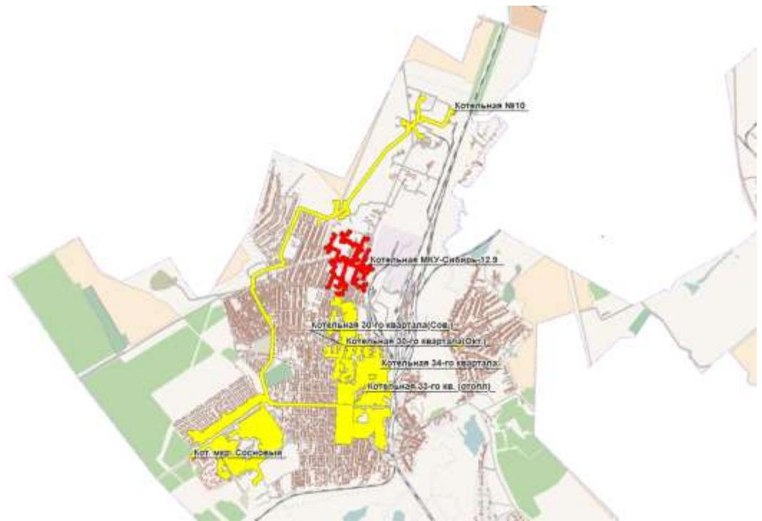
**Рисунок 22 - Зона действия источника котельной МКУ-12,9 с дефицитом располагаемой тепловой мощности**
