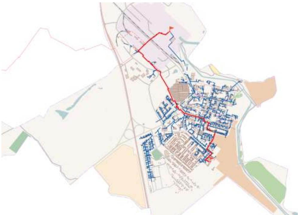
**Рисунок 23 - Путь движения теплоносителя от БелГРЭС АО «Кузбассэнерго» до конечного потребителя**
