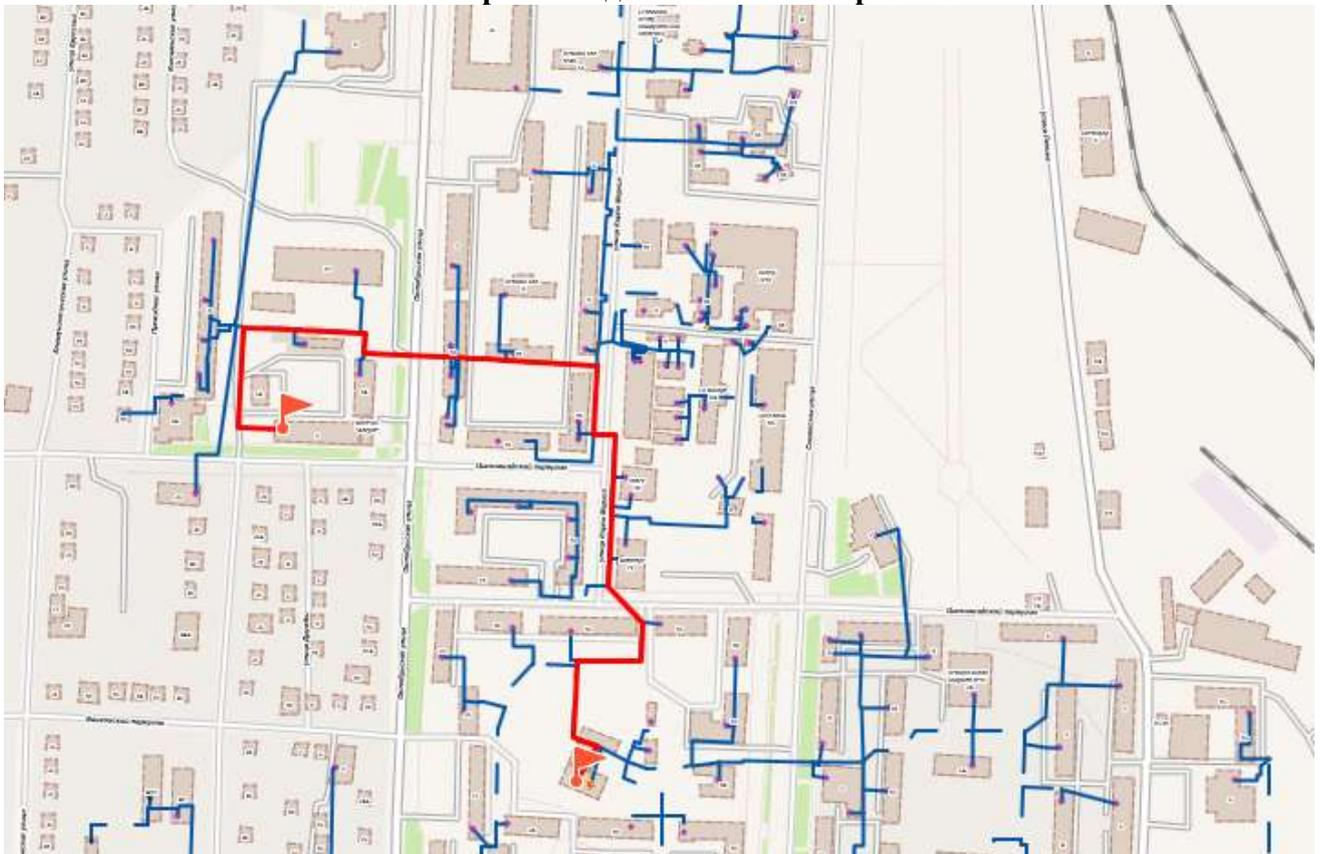
**Рисунок 38 - Путь движения теплоносителя от котельной 30-го квартала ООО «Теплоэнергетик» до конечного потребителя**
