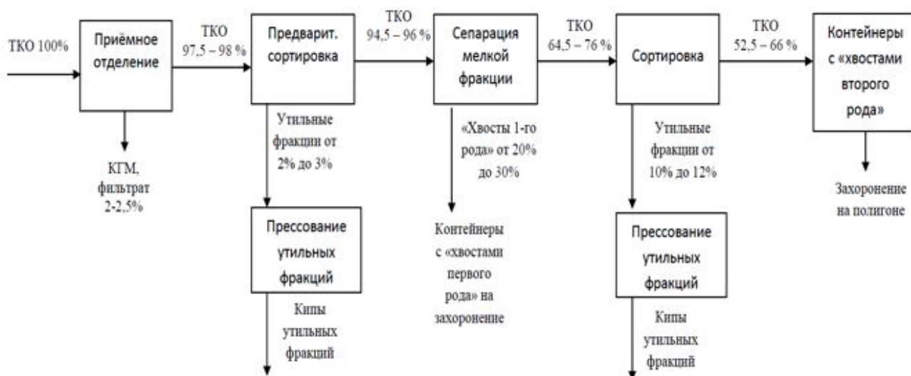
Принятая схема технологии сортировки и переработки отходов
