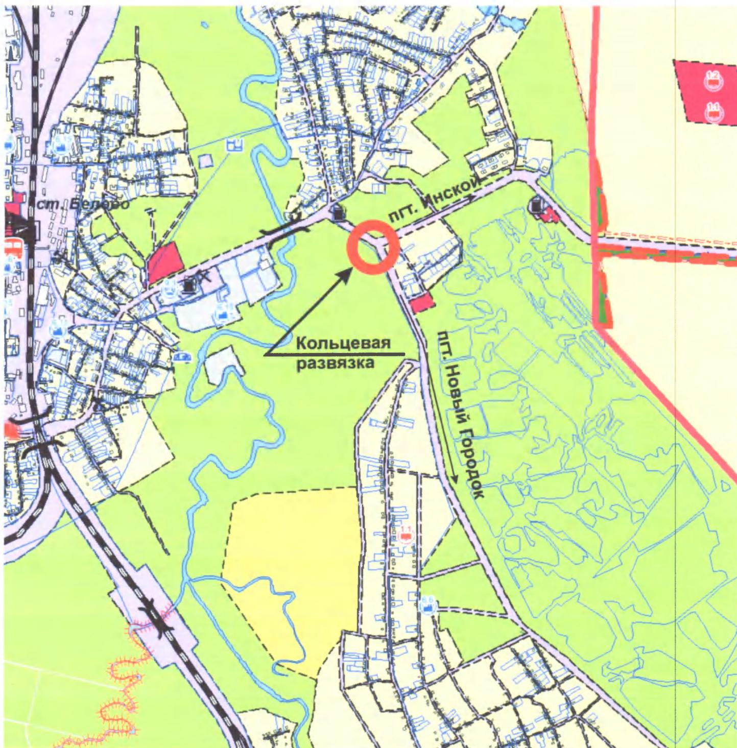
Предусмотреть кольцевую развязку на пересечении автомобильных дорог ул. Кемеровская и ул. Аэродромная
