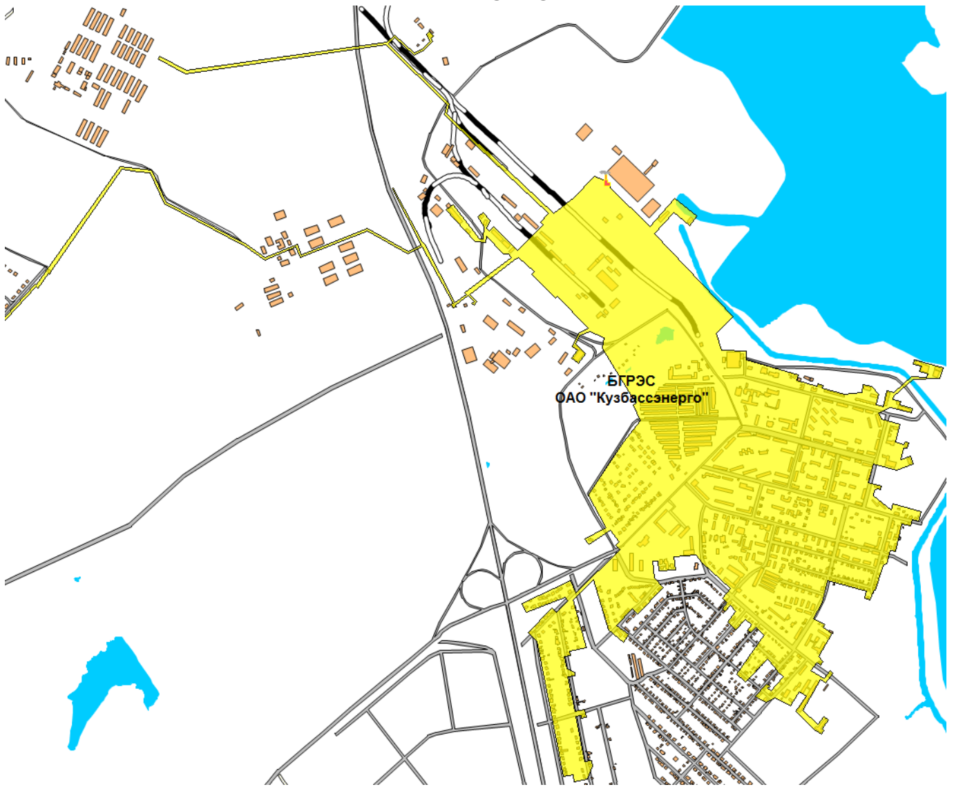
Рис. 2.1. Существующие зоны действия Беловской ГРЭС района пгт. Инской по состоянию на 2016 г.
